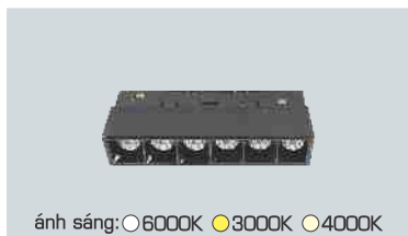
RNC 02 LED 6W - DC 48V 252.000 L112 x W22 x H44 Điện áp: DC 48V Bóng LED SMD 90Lm/W - RA90 Thân đèn: Hợp kim nhôm Góc chiếu: 24°
